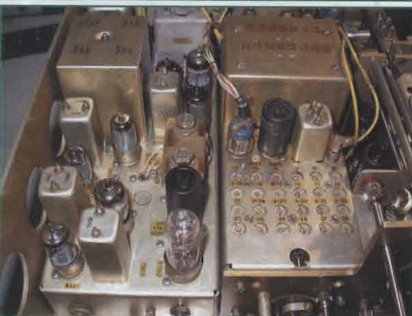
Dall'alto: foto 12: il nuovo C535 da 47pF nel BFO foto 13: basetta nel modulo AF con i nuovi C604, C607, C609 foto 14: gli schermi IERC su alcune delle valvole
