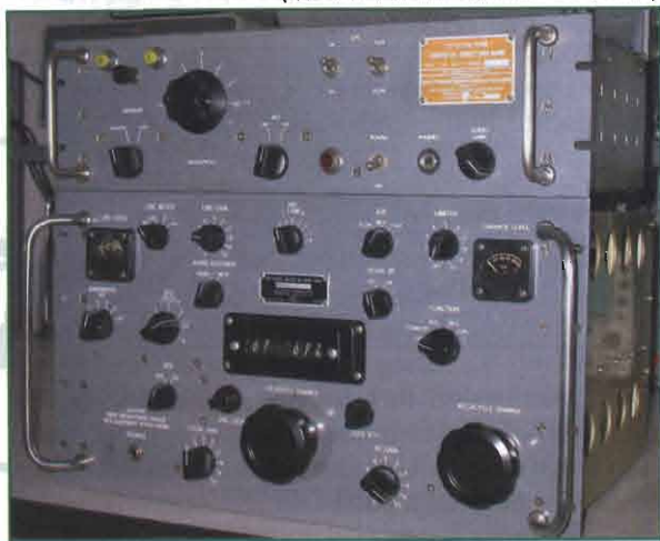
(foto 6: il 390A con il Converter SSB CV657A)
