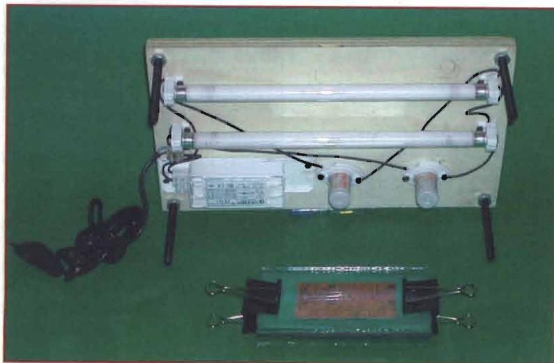
foto 1: il bromografo completato
