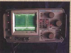
ANALIZZATORE DI SPETTRO TEKTRONIX 492/6 opt.6
