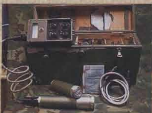
MISURATORE DI RADIOATTIVITA' RAM 63
